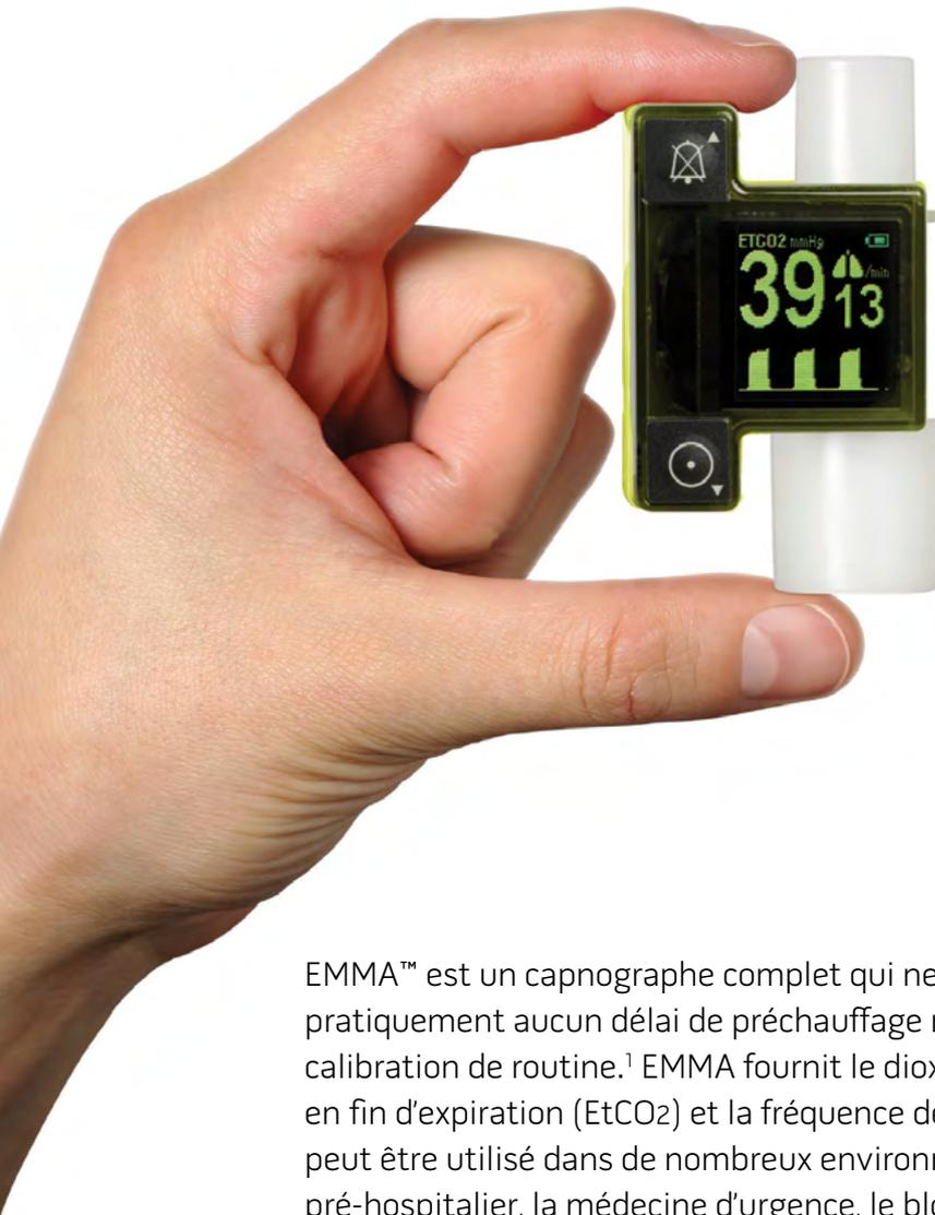
EMMA™ est un capnographe complet qui ne requiert pratiquement aucun délai de préchauffage ni aucune calibration de routine.<sup>1</sup> EMMA fournit le dioxyde de carbone en fin d'expiration (EtCO<sub>2</sub>) et la fréquence de respiration, et peut être utilisé dans de nombreux environnements, dont le pré-hospitalier, la médecine d'urgence, le bloc opératoire, les unités de soins intensifs et les soins de longue durée.
