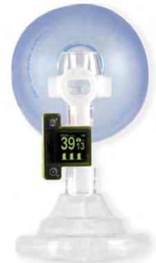
*EMMA peut être utilisé avec un circuit respiratoire pour fournir des mesures de CO<sub>2</sub>*
